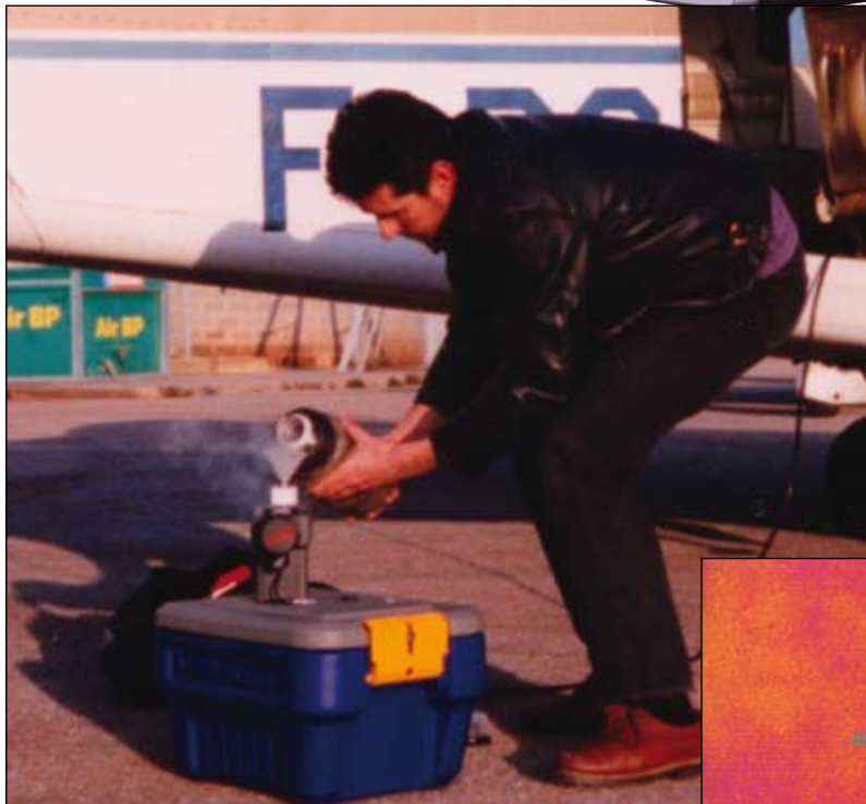
Remplissage à l'azote liquide de la caméra pour assurer son refroidissement. C'est le premier modèle que nous avons testé
