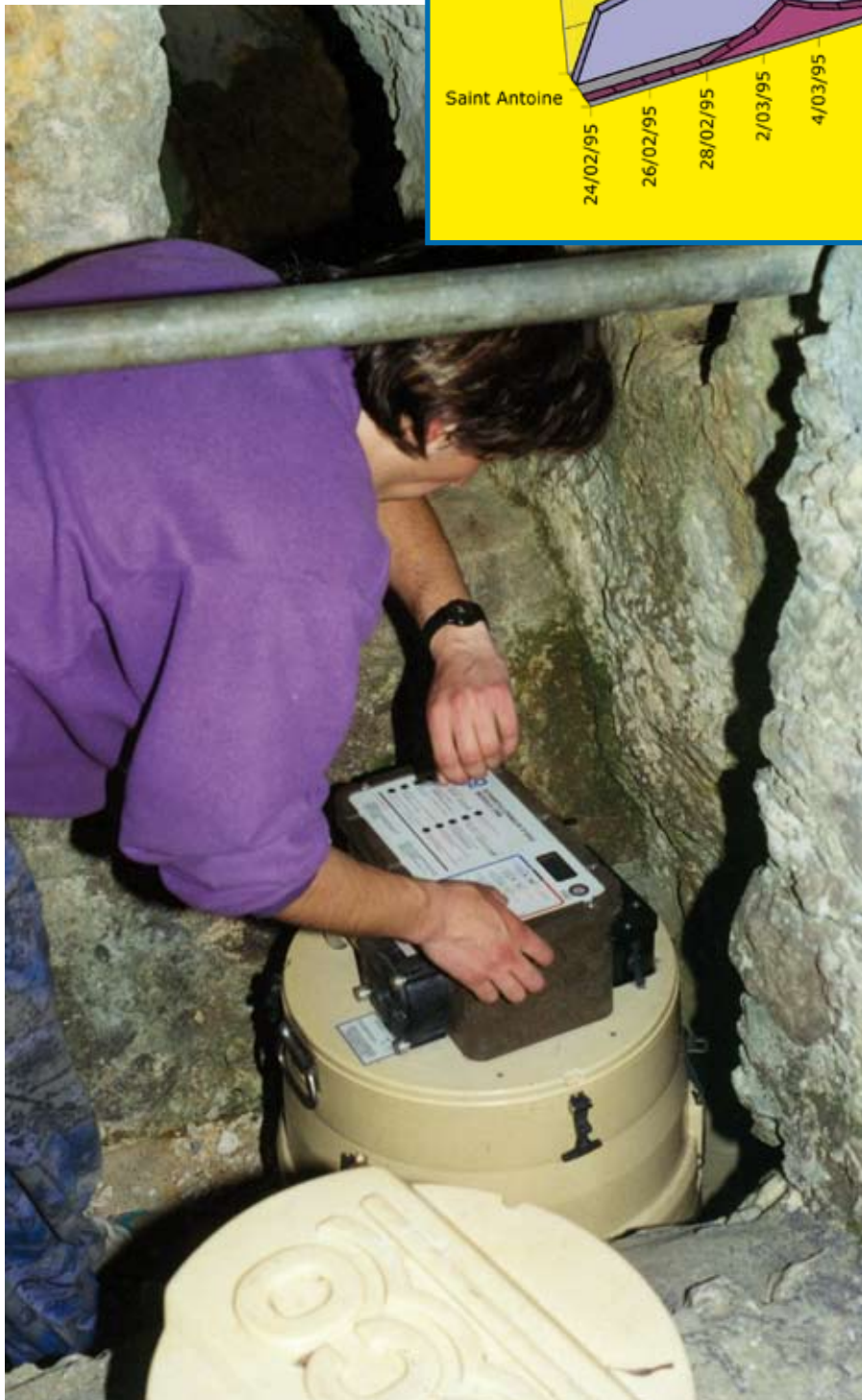
Mise en route d'un échantillonneur à la source de la Ripelle
